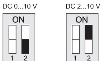
Les servomoteurs BMD1.2 sont réglés en usine pour un fonctionnement direct (DA) et un signal de commande en entrée de 0 à 10 Vcc.
