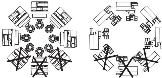
Figure 5 : Positions de Montage pour l'Eau Refroidie et pour Applications avec Atmosphère Condensante
