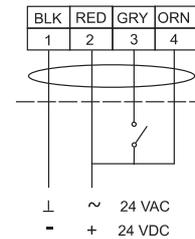
Commande 3 points (Flottant), Raccordement parallèle
